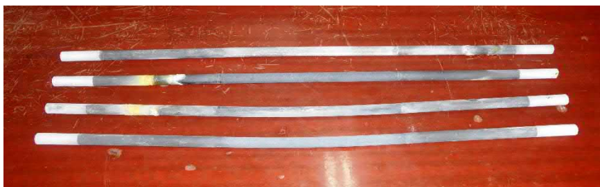
Рис.3. Карбидокремниевые нагревательные элементы, пришедшие в непригодное состояние.
