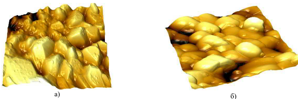
Рисунок 2. АСМ снимки образцов \text{La}_{0.9}\text{Ca}_{0.1}\text{ScO}_{2.85} : а) - необлученный; б)- облученный ионами Ar
