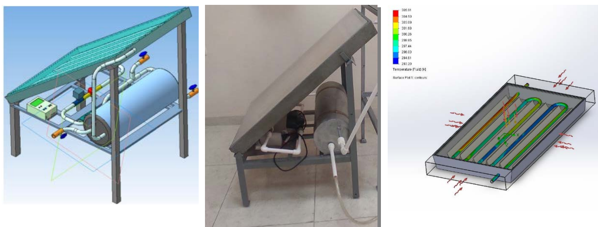
3-расм.а) CAD модель, б) тажриба намунасининг кўриниши, с) дастлабки симуляцион тадқиқот натижаси.
