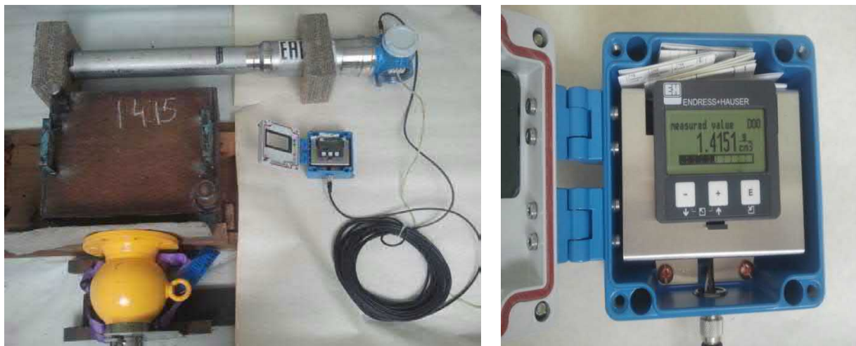
Рис.2. Градуировка радиоизотопного плотномера № P 9007001064 FHX-40: справа показаны: блок гамма-источника, свинцовый экран толщиной 15 мм, стенд имитатора с жидким имитатором №2 ( \rho=1415 г/дм 3 ) и детектор; слева показаны: дисплей блока обработки и анализа информации с открытой крышкой, где показано измеренное значение плотности жидкого имитатора №2 ( \rho=14151 г/дм 3 ).
