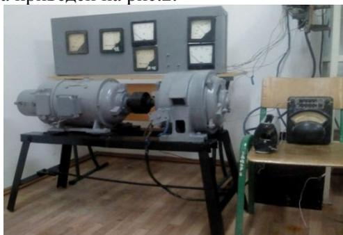
Рис.2. Вид электродвигателя и генератора ( $P=5000\text{Вт}$ ,  $U=380\text{В}$ )
