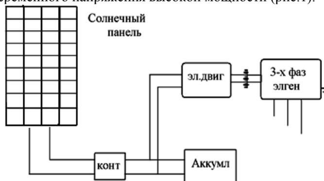
Рис.1. Блок схема электромеханического преобразователя.
