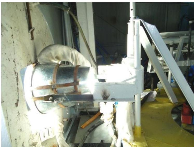
*Рис.1. Фокон, установленный в фокальную зону БСП.*
