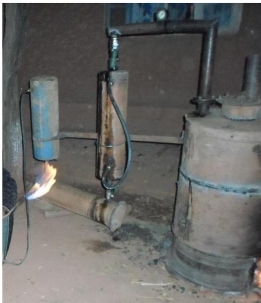
*Рис.1. Экспериментальная пиролизная установка для получения альтернативного топлива из биомассы.*
