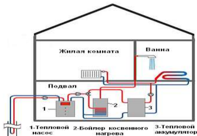
На рисунке приведена схема применения геотермальных вод в жилых коттеджах.
