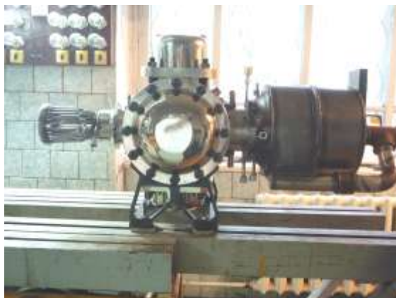
Рис.8. Комбинированный двигатель с горелочным устройством на стенде.
