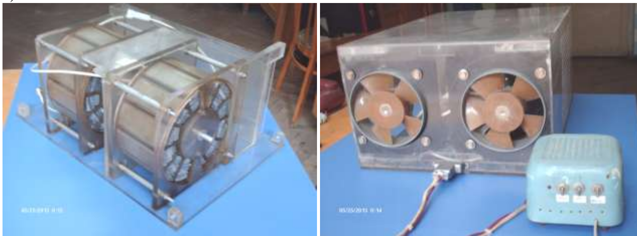
Рис. 1. Двухступенчатый бытовой испарительный охладитель воздуха с ВРТ без кожуха (слева, вид сбоку) и с кожухом (справа, вид сзади). Видны два ВРТ на общем валу (слева) и вентиляторы подачи воздуха (справа).
