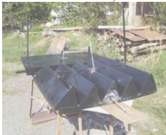
Рис.1. Общий вид мобильной солнечной водонагревательной установки без полиэтиленовой пленки (на переднем плане).
