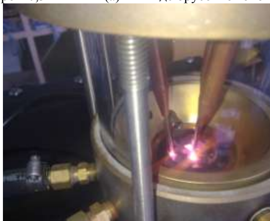
Рис.3. Процесс нагрева технического кремния резистивным нагревом с использованием вольфрамовых электродов при токе до 300 А.
