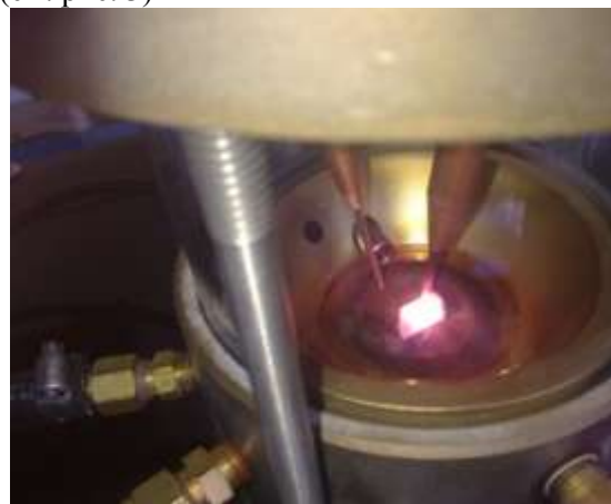
Рис.3. Процесс нагрева технического кремния резистивным нагревом с использованием вольфрамовых электродов при токе до 300 А.
