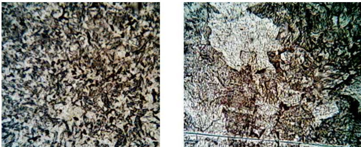
Рис. 6 Дефекты микроструктур: а) – перегрев упрочняемой поверхности; б) – неоднородная структура закалки
