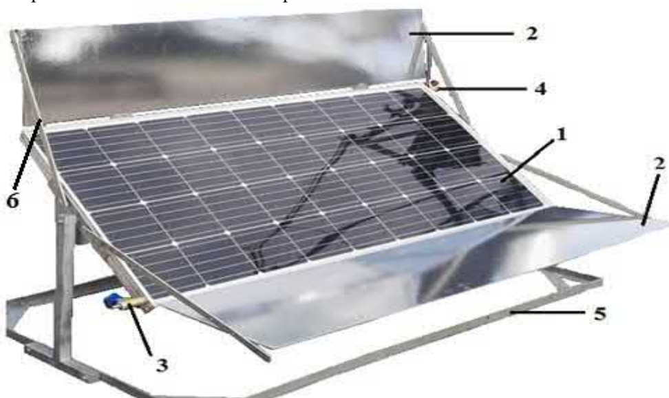
Рис.1. Фото тепловая батарея подготовка к измерению параметров в натуральных условиях.
