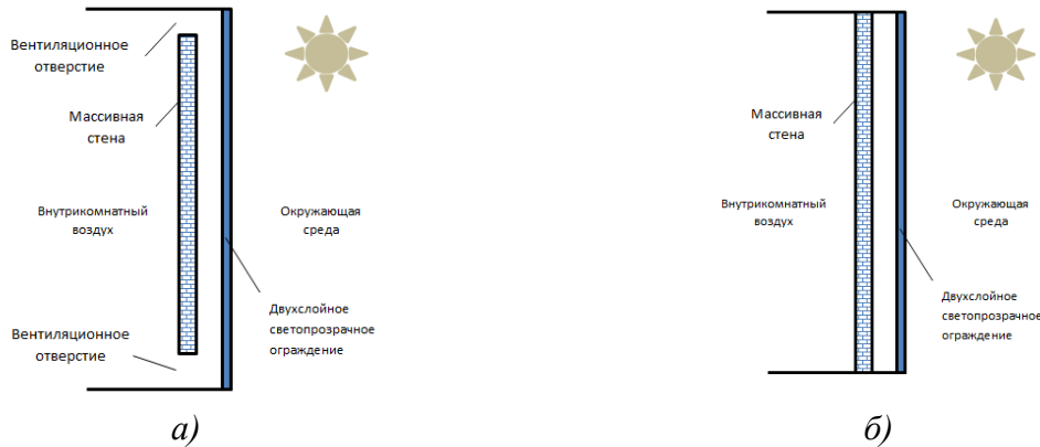
Рис.1. Рассматриваемые варианты стены Тромба: а- вентилируемая стена Тромба; б- стена Тромба без вентиляции.
