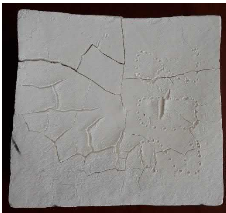
Рис. 2 Внешний вид образца теплозащитного материала на основе волокна ZrO_2 после экспозиции в течение 2 часов в фокусе БСП при T \approx 1550 - 1600^\circ C
