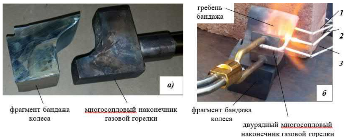
Рис. 3 Многосопловые наконечники газовой горелки для закалки бандажа локомотивного колеса: а) многосопловый наконечник газовой горелки; б) двурядный многосопловый наконечник: 1 – термopа на гребне бандажа, 2 – термopа на изгибе бандажа, 3 – термopа под поверхностью катания
