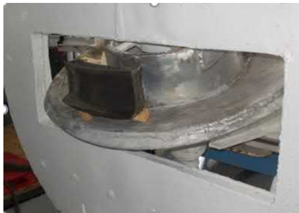
Рис. 2 Установка фрагмента бандажа локомотивного колеса для проведения эксперимента по закалке в фокусе БСП
