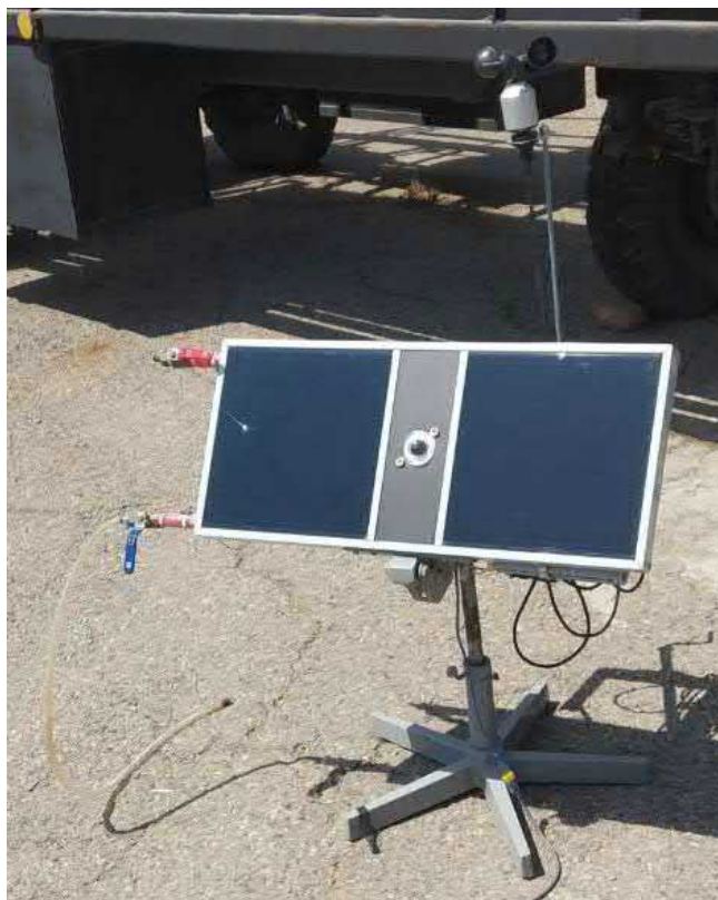
Рис.1. Фото экспериментальной установки для измерения фотоэлектрических и фото-тепло-преобразовательных параметров CIGS в естественных условиях
