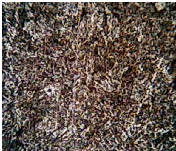
Рис. 5 Структура поверхностного слоя стали после закалки при температуре 880^{\circ}\text{C} , \times 1000
