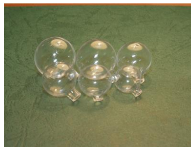
Рисунок 4. Изготовленные кварцевые мембраны для термохимического датчик утечки с термопарой типа «Горошина»
