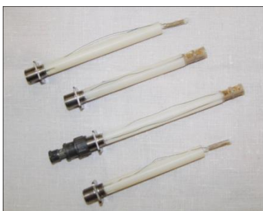
Рисунок 10. Термохимический датчик утечки водорода с водородом и водонепроницаемым тефлоновым корпусом и с термопарой
