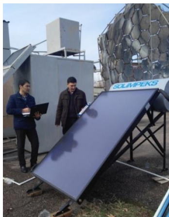
Рис. 2. Процесс измерения падающей на наклонную поверхность солнечной радиации в натуральных условиях в полигоне МИСЭ.
