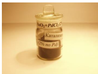
Рисунок 2. Сенсорное вещество для лабораторных тестовых исследований для термохимического датчика утечки водорода на основе диоксида марганца палладируемого с повышенными добавками PdCl 2 (с концентрациями от 1 – 10% палладия)- для тестирования результатов компьютерного моделирования в среде ANSYS
