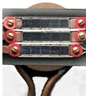
Рис. 2. Матрица электрически связанных солнечных элементов с общей площадью 30 \times 24 \text{ мм}^2 с водяным охлаждением
