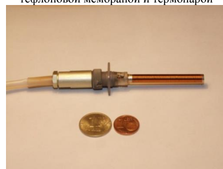
Рисунок 9. Термохимический датчик утечки водорода с терморезисторным чувствительным элементом (сверхтонкая медная нить, навитая на тонкостенную алюминиевую трубку)
