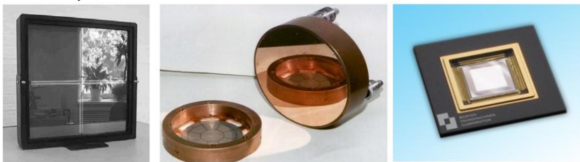
Рис.3. Виды деформируемых зеркал. Слева деформируемое управляемое зеркало размером 220 x 220 мм. В центре - охлаждаемое деформируемое зеркало лазерного резонатора диаметром 100 мм. Справа – деформируемое зеркало в виде микросхемы размером 20 x 20 мм.
