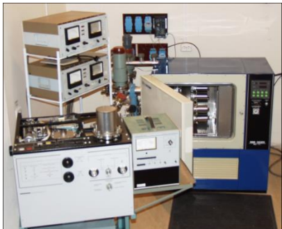
Рисунок 14. Стенд для испытаний датчиков в установке «Эдельвейс-001» [18,19]
