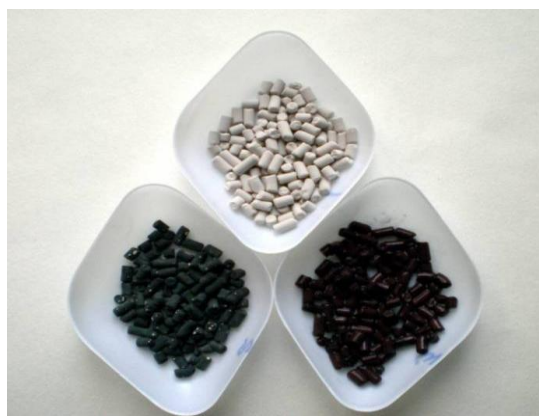
Рис. 1 Исходный (сверху) и модифицированный цеолит, содержащий наночастицы оксида меди (слева внизу) и наночастицы меди (справа внизу).
