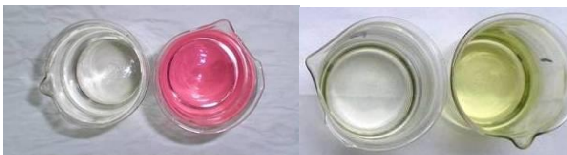
Рис. 7. Обесцвечивание раствора MeO с pH=2(слева) и pH=8 (справа) под действием солнечного света через 15 минут после начала облучения
